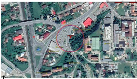
Fig. 5. Intensity radii for fireball, 50kW/m2 (BLEVE)
