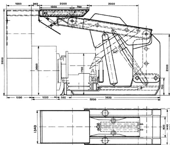
Fig. 2. The VHP750 sublevel caving shield
