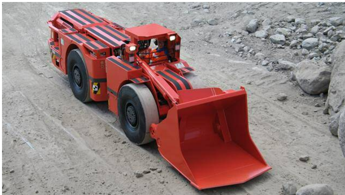
Fig. 1. Vedere de ansamblu a mașinii de încărcat, transportat și depozitat, model TORO 151 produsă de firma Sandvik
