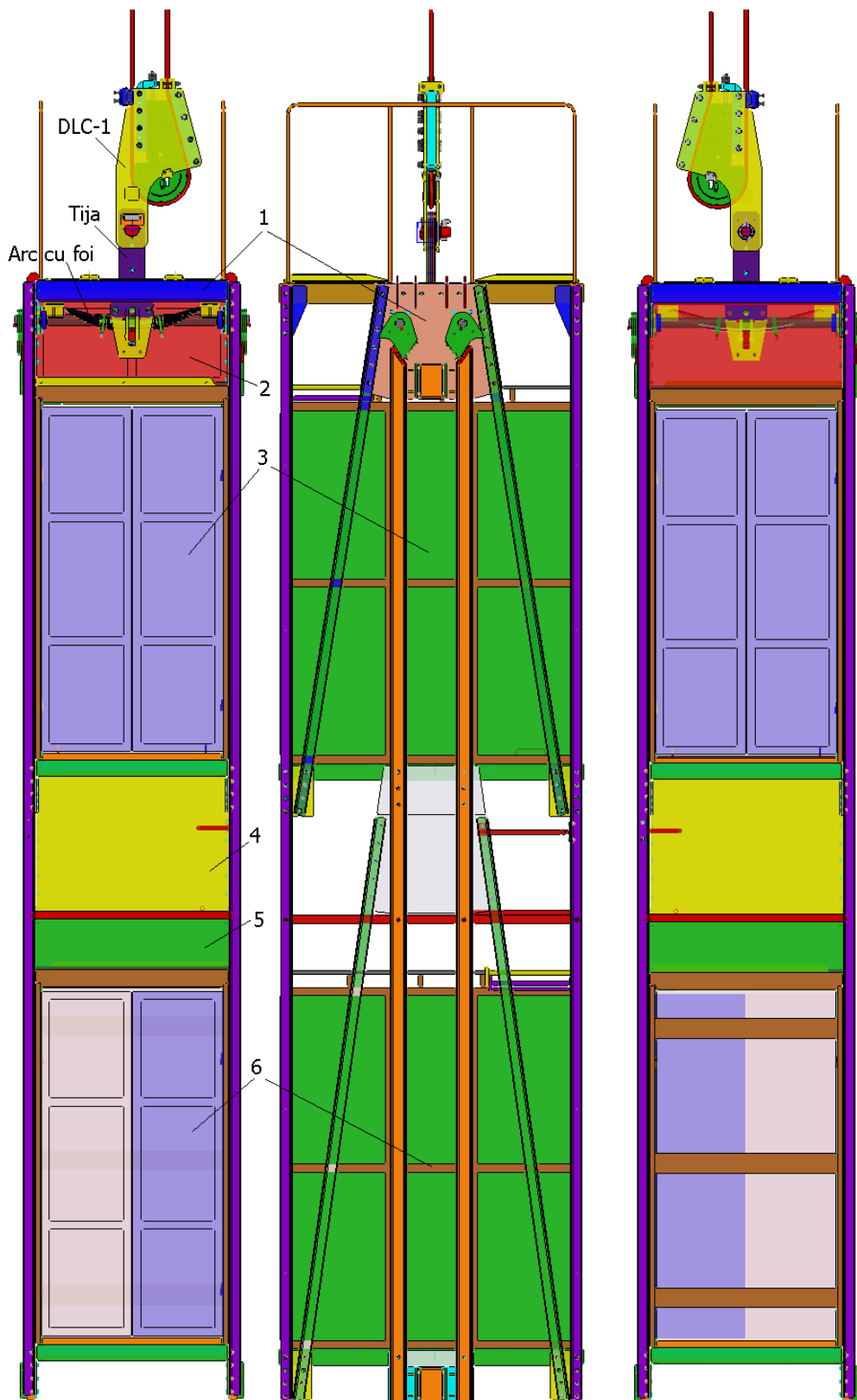
Fig. 2. Construcția coliviei cu două etaje
