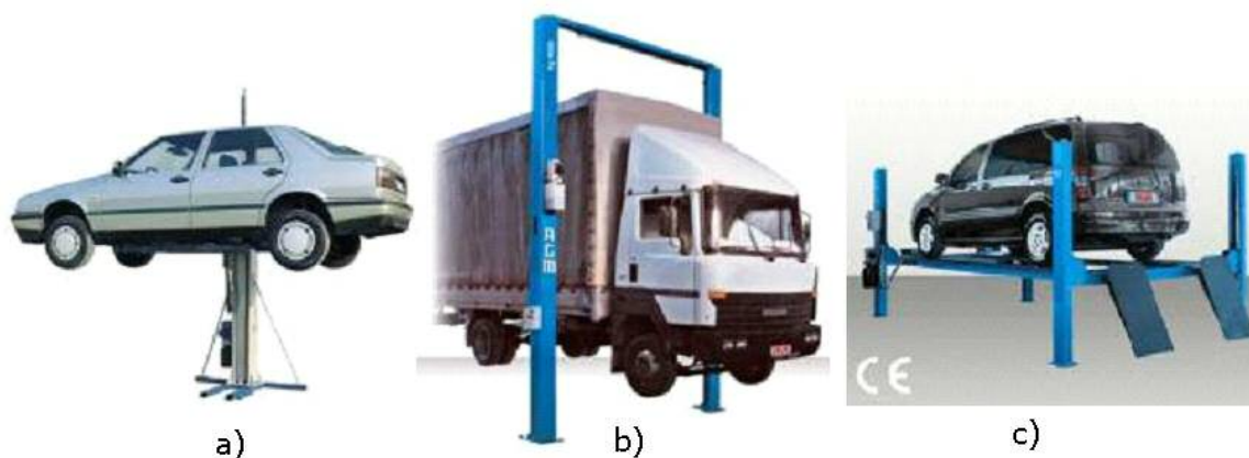
Fig. 1. Elevatoare electrohidraulice cu una, două și patru coloane
