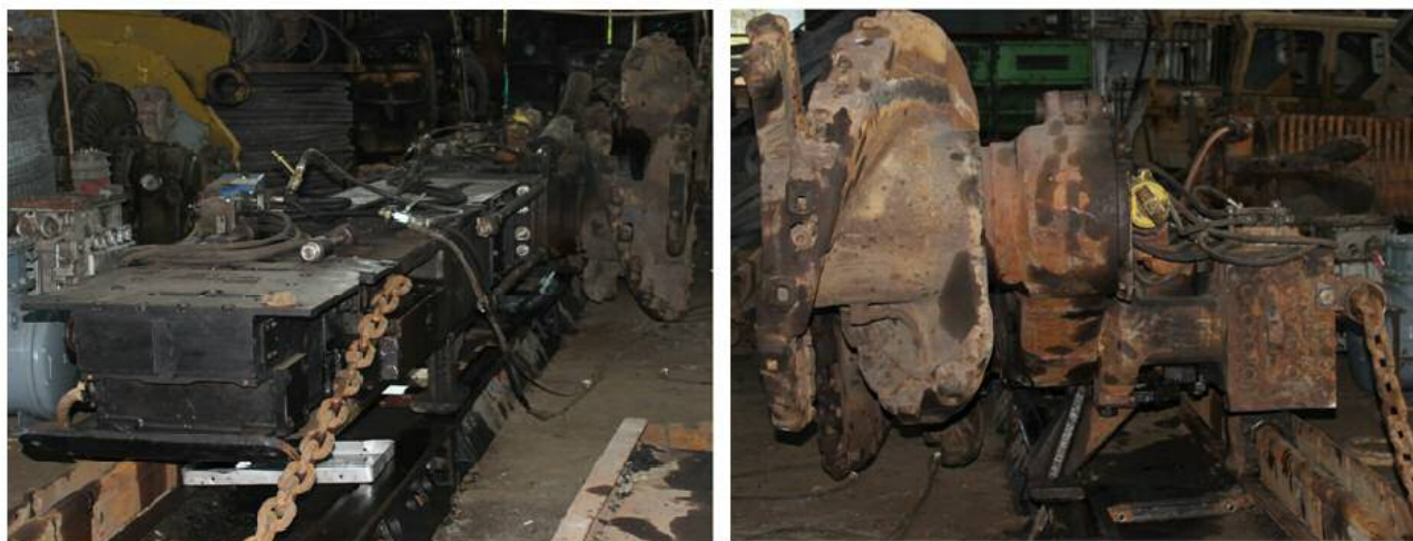
Fig. 11. Montarea combinei pe transportor [3]
