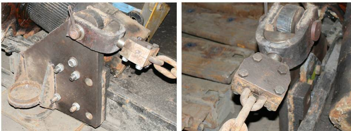
Fig. 10. Sistemul de legare a lanțului la stația de întoarcere executat la E.M. Lonea [3]
