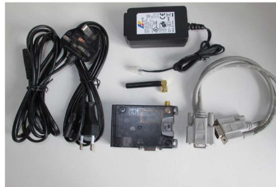
Figura 4. Modemul Cinterion BGS2T(RS232)
