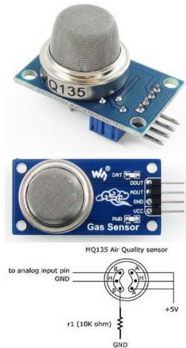
Fig.2 Senzor de gaz MQ-135. Detectează calitatea aerului respirabil
