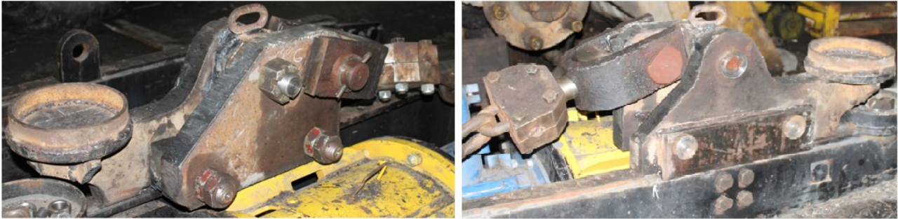
Fig. 5. Sistemul de legare a lanțului la stația de acționare executat la E.M. Lonea [3]
