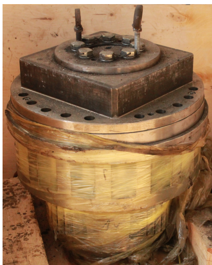
Fig. 5. Transmisia planetară finală a brațului cu arborele de ieșire cu cap pătratic pentru montarea organului de tăiere
