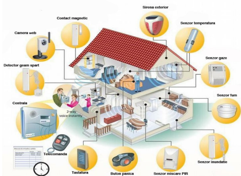
Fig. 1 Sistem de alarmă
