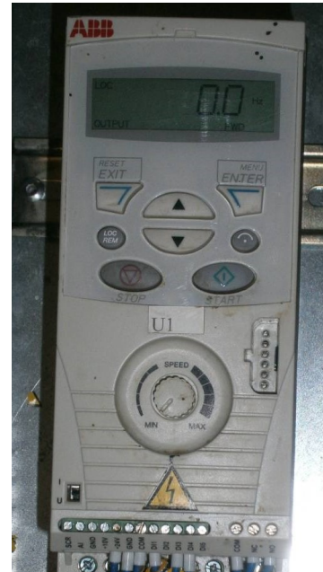
Fig. 5 Convertorul de frecvență este de tip ABB ACS 150
