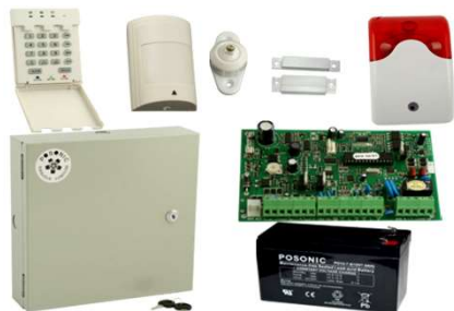
Fig. 2 Componentele unui sistem de alarmă
