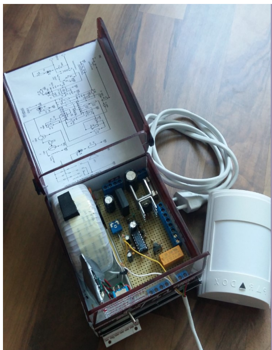
Fig. 4 Stand de simulare a alarmării la efracție
