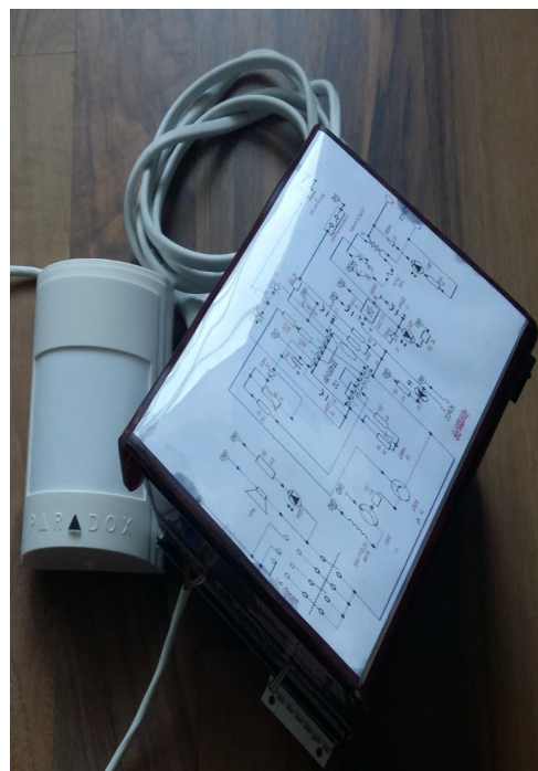
Fig. 5 Schema de montaj a standului de alarmare la efracție
