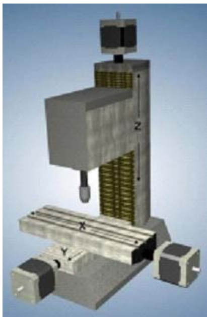
Fig.3. CNC cu masă în cruce
