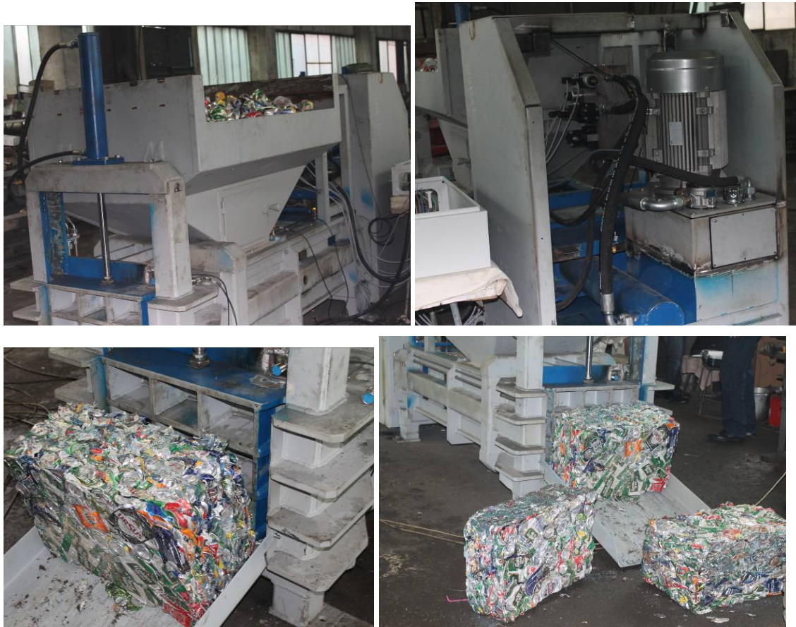
Fig. 10. Realizarea și încercarea presei de balotat doze de aluminiu
