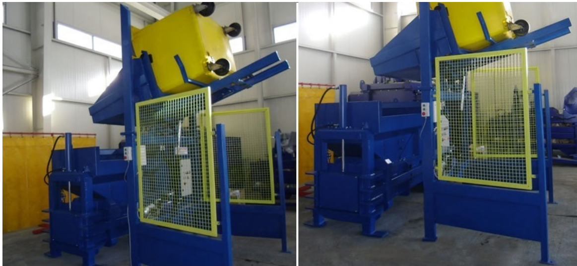
Fig. 11. Modul de alimentare a preseii cu dispozitivul de basculat DBP 1100L
