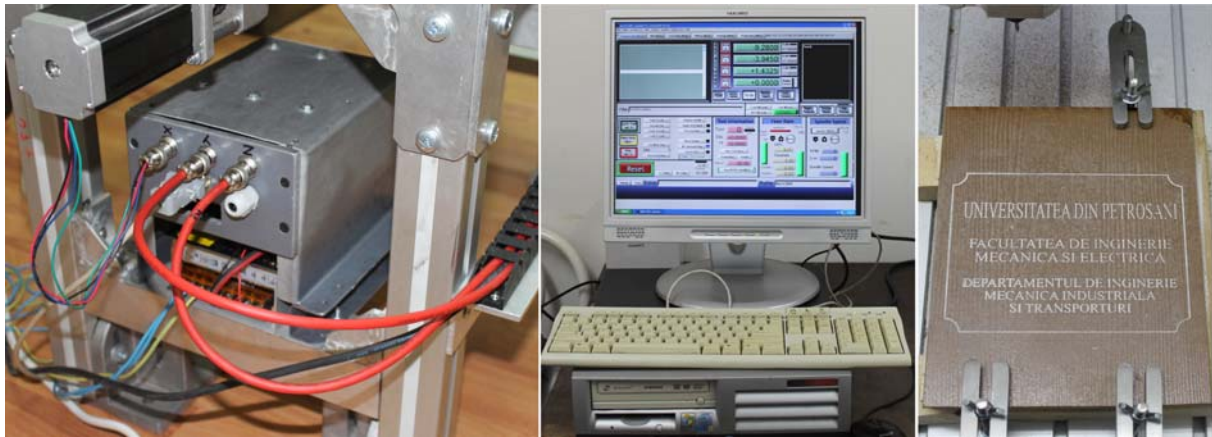
a) b) c) Fig. 10. Instalația electrică, calculatorul de comandă și placa gravată
