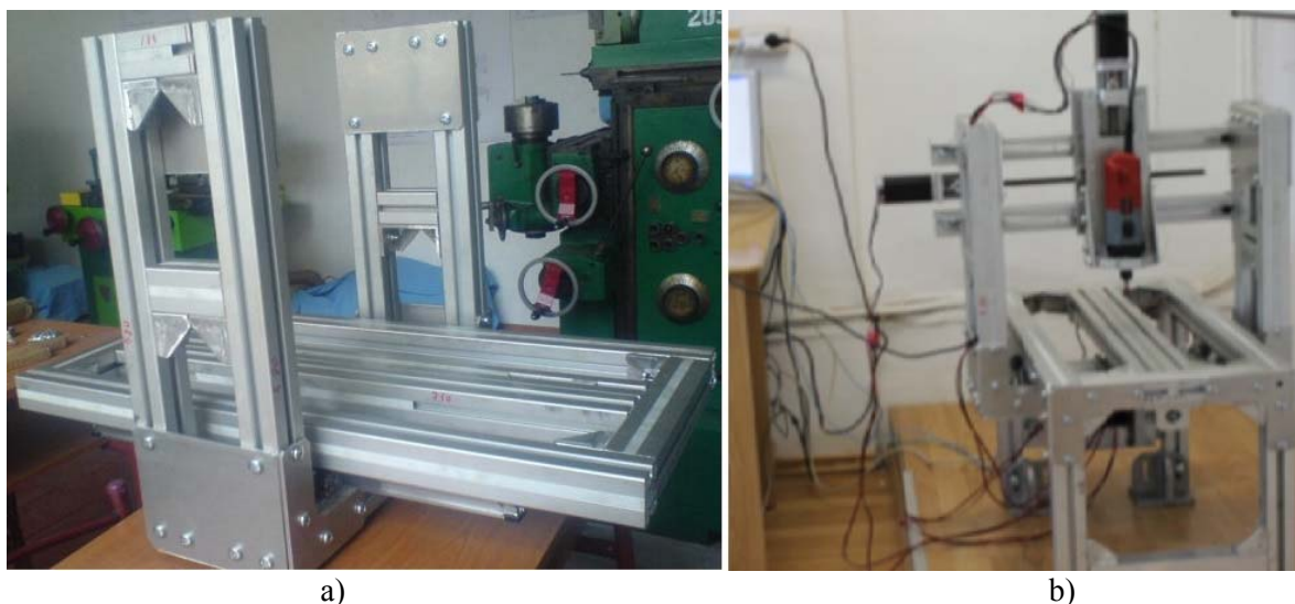
Fig. 8. Modul de realizare a mașinii de frezat cu comandă numerică după trei axe
