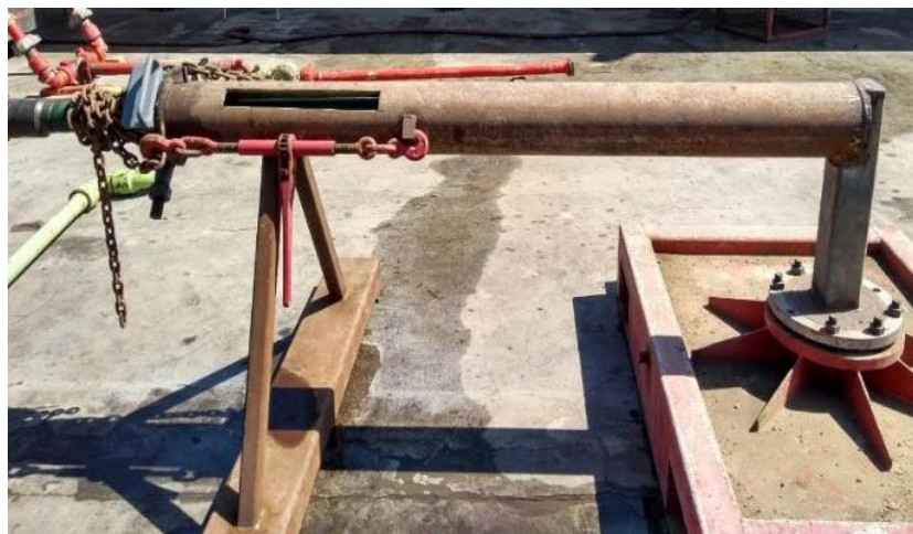
Fig. 2. Casing test stand
