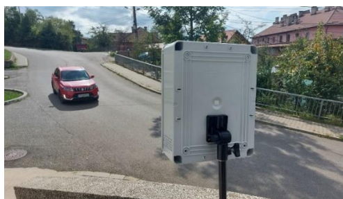
Fig. 3. Aspecte din timpul testelor efectuate în campusul Universității din Petroșani asupra stațiilor integrate de monitorizare a aerului și a traficului
