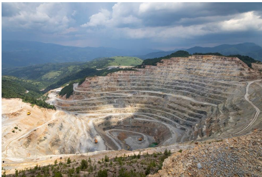
Fig. 1. Carieră de exploatare în trepte – zona Roșia Montană
