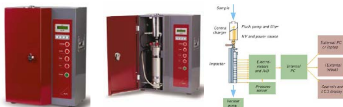
Dispozitivul ELPI și schema funcțională
