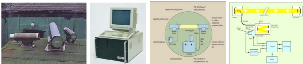
Senzorii sistemului „System 300”, analizorul AR 500S, principiul de funcționare și schema bloc Performanțele sistemului „System 300”:
