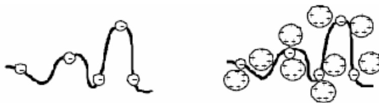
Fig. 1 Mecanismul de floculare cu ajutorul unui polimer cu grupări funcționale anionice
