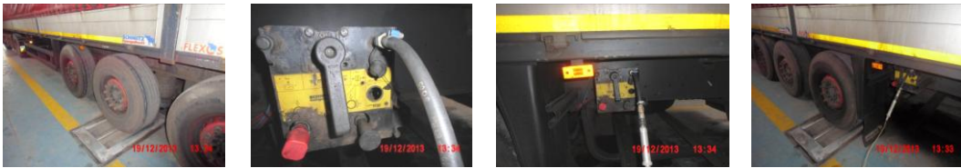
Fig.5.1 Verificarea sistemului de frânare
