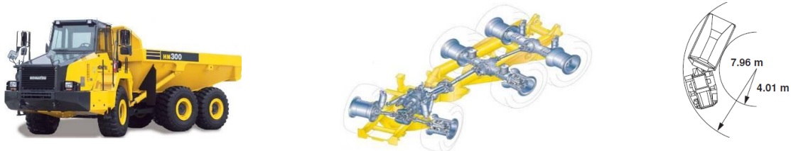
Fig.3.1 Direcția articulată la vehiculul Komatsu HM300-2
