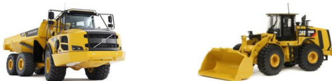
Fig.6.1 Dumper de 30 t și încărcător frontal cu cupa 4/4,5 \text{ m}^3
