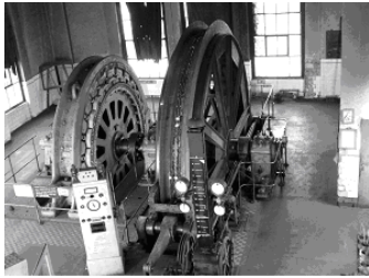
Fig. 1. Monocable drive wheel (Köpe)
