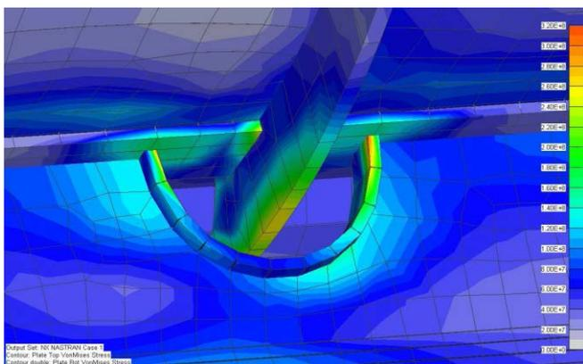
Fig. 3. Equivalent von Mises stress [N/m<sup>2</sup>]
