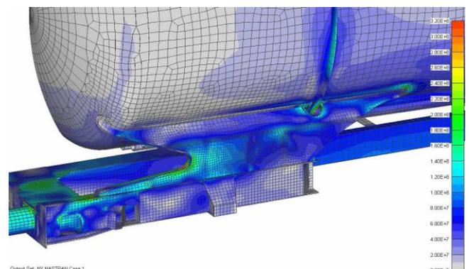
Fig. 1. Equivalent von Mises stress [N/m<sup>2</sup>]
