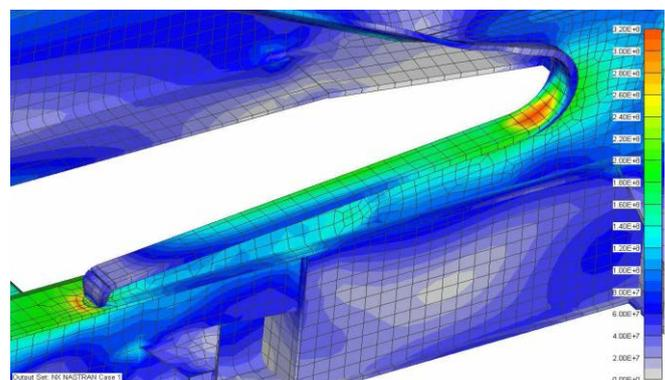
Fig.2. Equivalent von Mises stress [N/m<sup>2</sup>]
